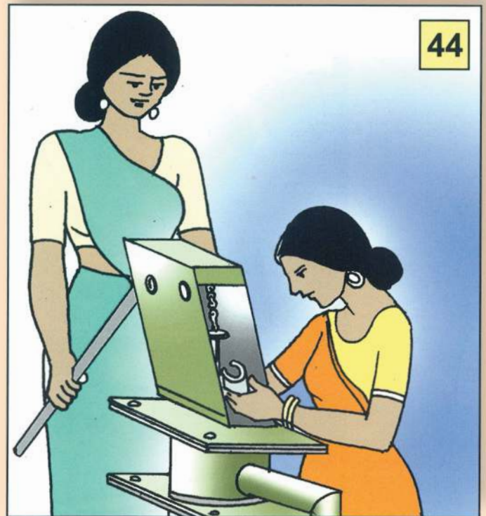
चेन कपलर के नीचे लगा चेन सपोर्टिंग टूल हैण्डल नीचे दबाकर हटा लेते हैं।
